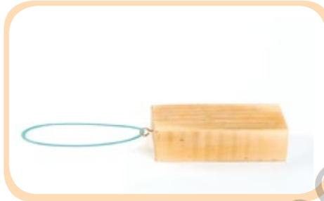
**Paso 2** Ubicaron el bloque sobre la superficie con papel de lija. Luego, tiraron del elástico y observaron cuánto se estiraba antes de que el bloque se pusiera en movimiento. Repitieron el procedimiento con la superficie de madera y la baldosa.
