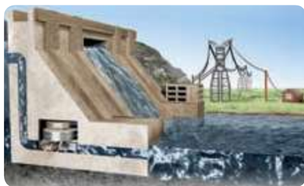
Central hidroeléctrica: utiliza la energía potencial gravitatoria del agua contenida en un embalse de gran altura. Su caída hace funcionar un generador que produce energía eléctrica.
